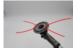
Hängen Sie die Mähfäden in der U-Form in das Basisteil. Beispiel: Doppelbestückung zum Mähen von Gras und Unkraut
