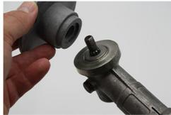
Setzen Sie das Basisteil auf die Zentrierung des Dickichtmessers. Diese beträgt im Durchmesser 25,4mm oder 20mm
