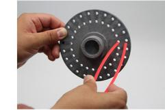
Schneiden Sie sich die Mähfäden auf die passende Länge zu. Empfohlenes Schnittmaß für die Bürste: 20cm
